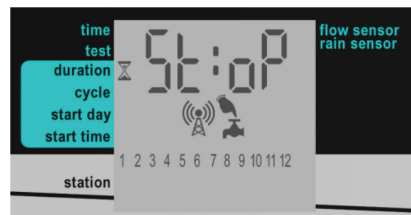
Figura 16: Detención de testeo de secuencia
